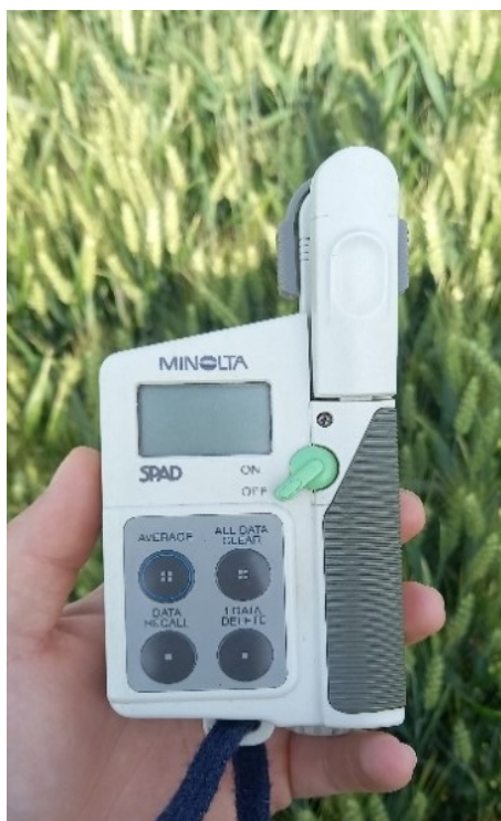
Figura 6: Strumento per la misurazione della clorofilla fogliare "SPAD-502 Plus" (foto propria)
