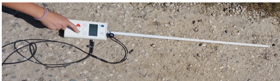
Figura 4: Ceptometro in fase di taratura (foto propria)
