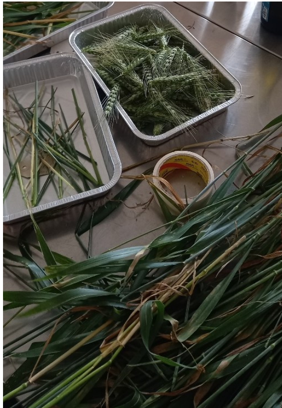
Figura 7: Separazione di foglie, fusti e spighe di frumento per le relative misurazioni dell'umidità (foto propria)
