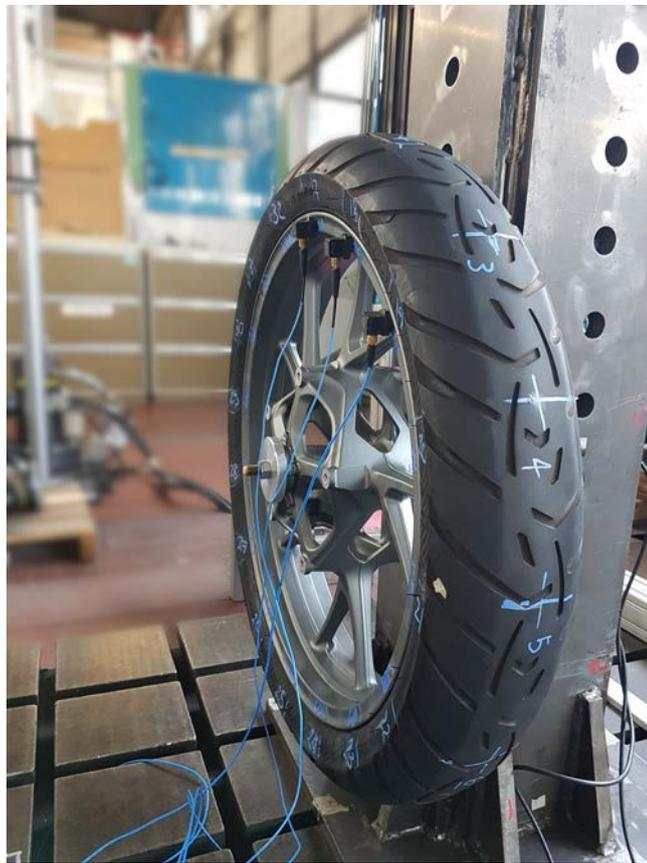
Figura 4.9: Montaggio dello pneumatico sulla colonna utilizzata per il fissaggio libero.
