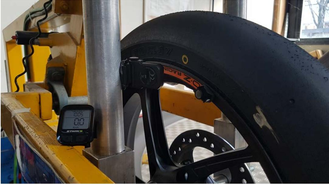
Figura 3.43: Strumentazione utilizzata nella misurazione del raggio effettivo di rotolamento
