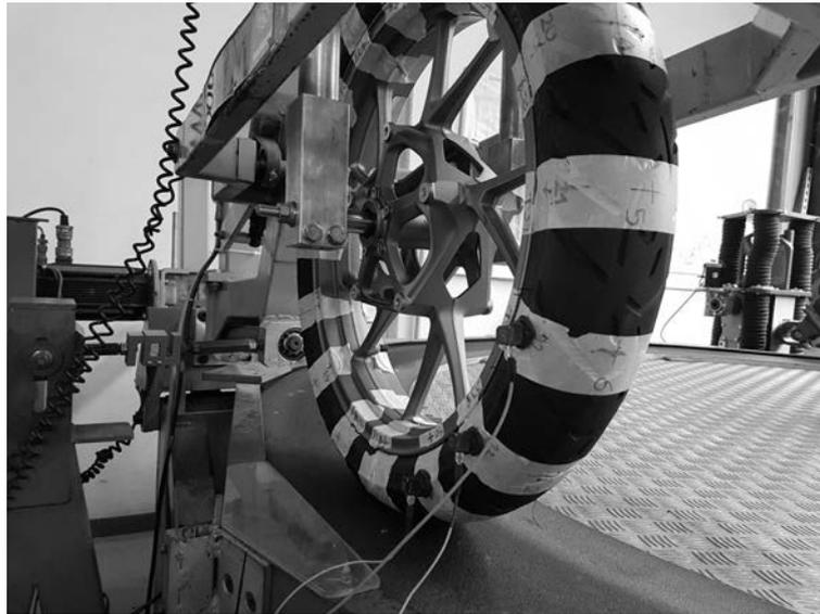
Figura 4.36: Analisi modale di uno pneumatico sottoposto a carico verticale, fissato sul *MotoTireMeter*
