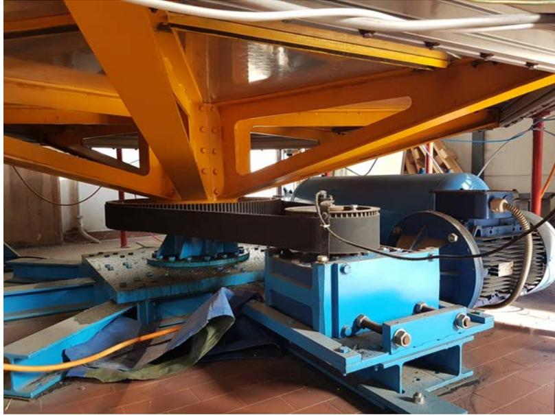
Figura 3.41: Trasmissione del disco rotante
