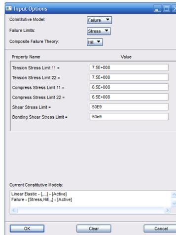
Figura 2.29: Finestra di dialogo per l’inserimento delle caratteristiche di resistenza
