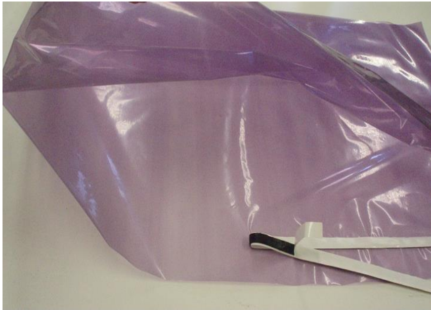
Fig. 2.11 Inizio della stesura del butilene su un lato del sacco
