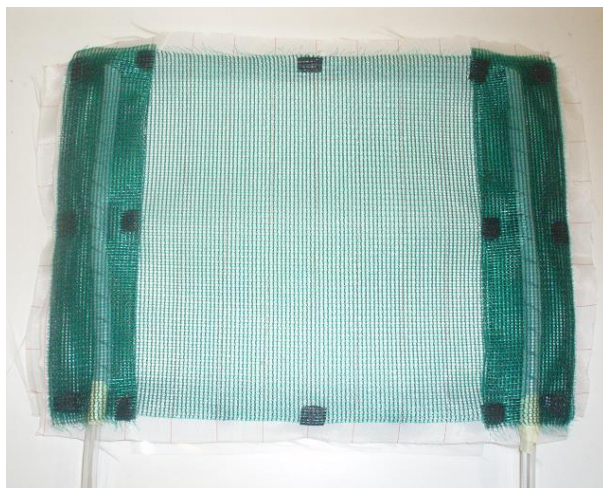
Fig. 2.10 Applicazione delle ultime striscioline di rete flow mat per coprire i canali.
