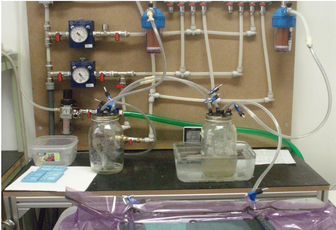
Fig. 2.17 Foto dell'apparato di infusione completo e collegato al sistema di vuoto. Soluzione con due vasi.
