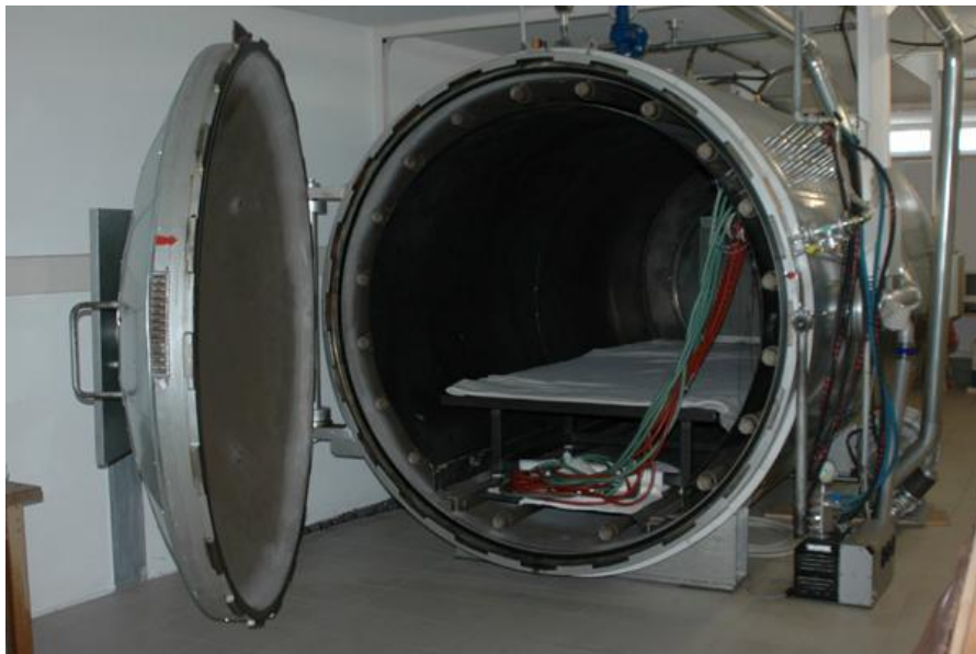
Fig. 1.8 Immagine di un'autoclave industriale
