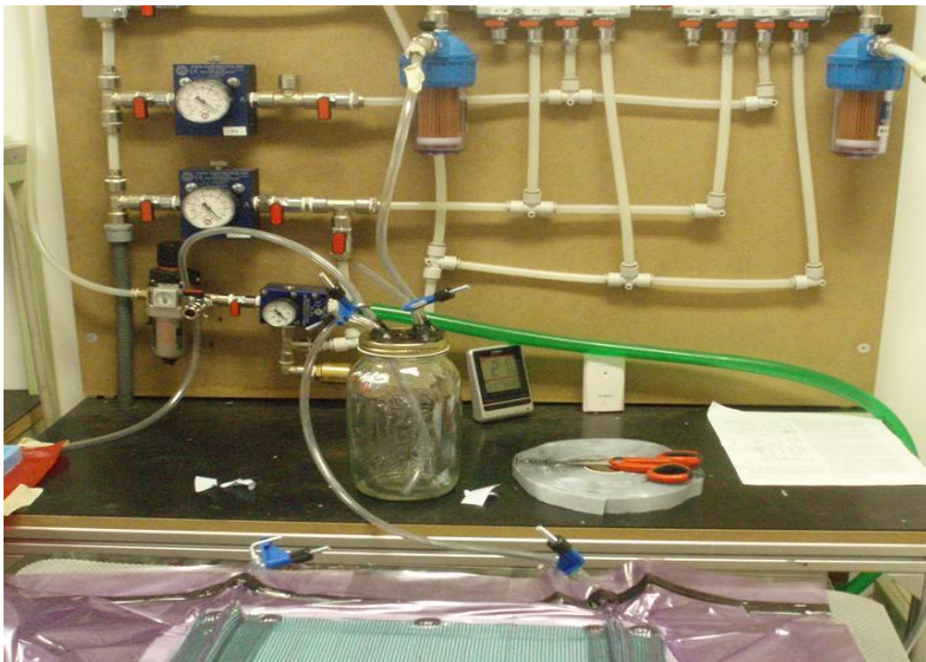
Fig. 2.16 Foto dell'apparato di infusione completo e collegato al sistema di vuoto (soluzione ad un vaso).
