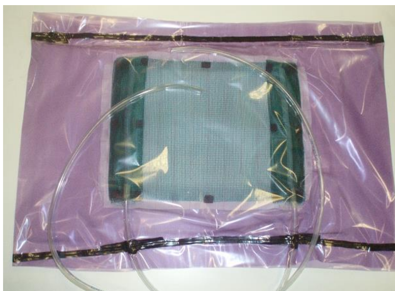
Fig. 2.14 Il sacco è pronto per essere collegato al sistema di vuoto.
