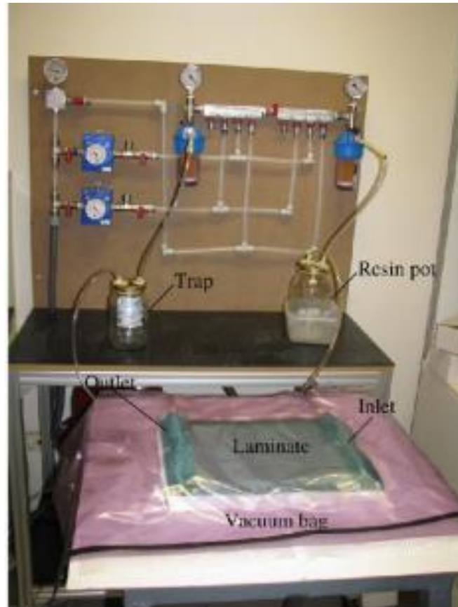
Fig. 2.15 Schema di collegamento tipico dei vasi all'impianto di vuoto e al sacco.
