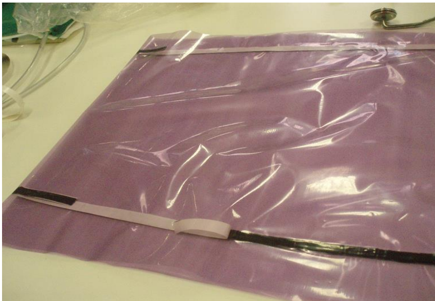
Fig. 2.12 Chiusura del lato posteriore del sacco (quello dove non dovranno passare i canali di ingresso ed uscita).
