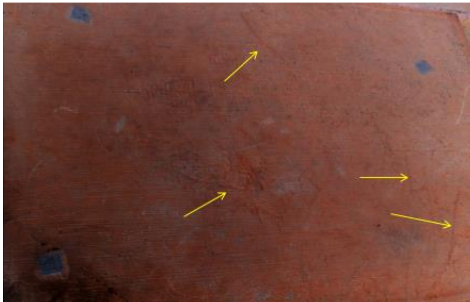
Fig. 2.1 Stampo in vetro prima della raschiatura della resina rimasta attaccata. I colori sono invertiti per evidenziare i residui di resina rimasti sulla lastra.
