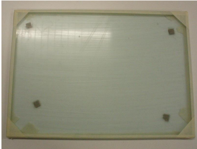
Fig. 2.4 Lastra di vetro completamente coperta sui bordi e agli angoli con scotch carta
