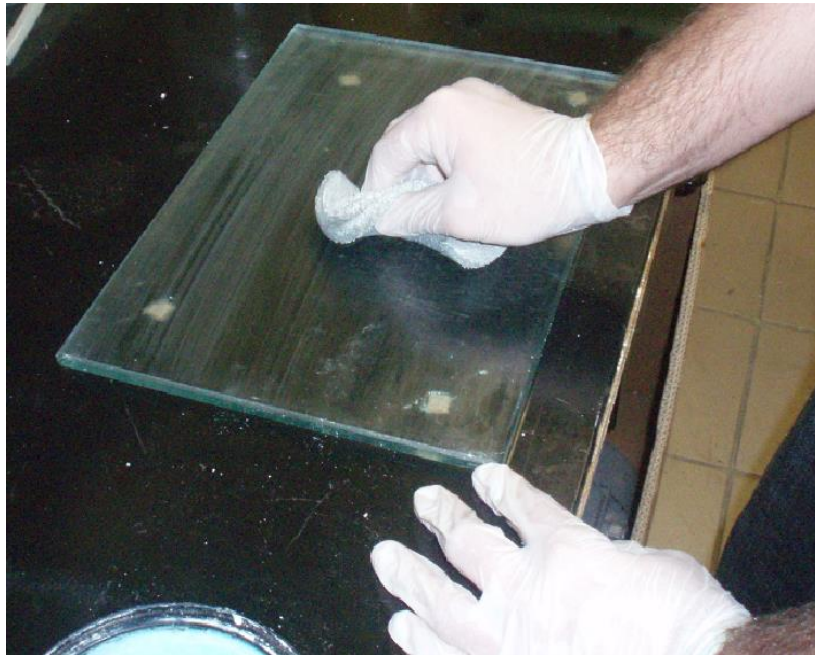
Fig. 2.2 Applicazione di uno o più, strati di cera sulla lastra di vetro.
