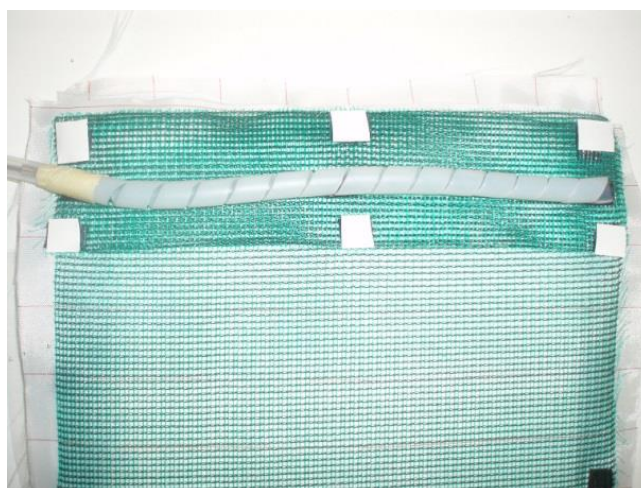
Fig. 2.9 Applicazione dei canali di ingresso ed uscita della resina.
