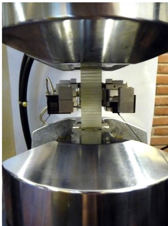
Fig. 16 Provino inserito nella macchina di trazione, con l'estensometro montato.
