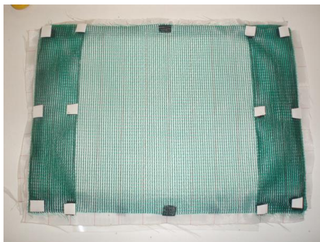
Fig. 2.8 Applicazione delle striscioline di rete flow-mat ai bordi dello stampo.
