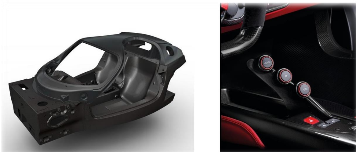
Fig. 1.3 Il telaio ed un dettaglio degli interni della nuova Ferrari "LaFerrari" in materiale composito in fibra di carbonio
