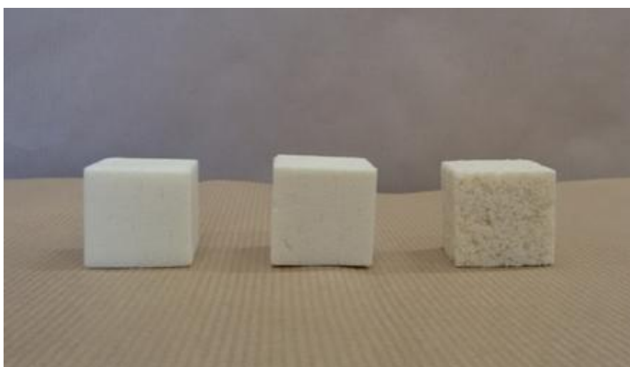
Figura 8.2. Campioni di schiume ad indice NCO 300 preparate con percentuali di poliolo da glicolisi pari rispettivamente al 50%, al 75% ed al 100% (da sx verso dx).
