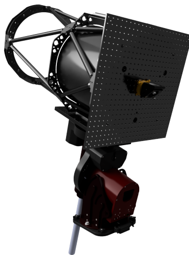
Figura 3.5: Render della breadboard installata sulla culatta di GaliQEye con flip mirror.
