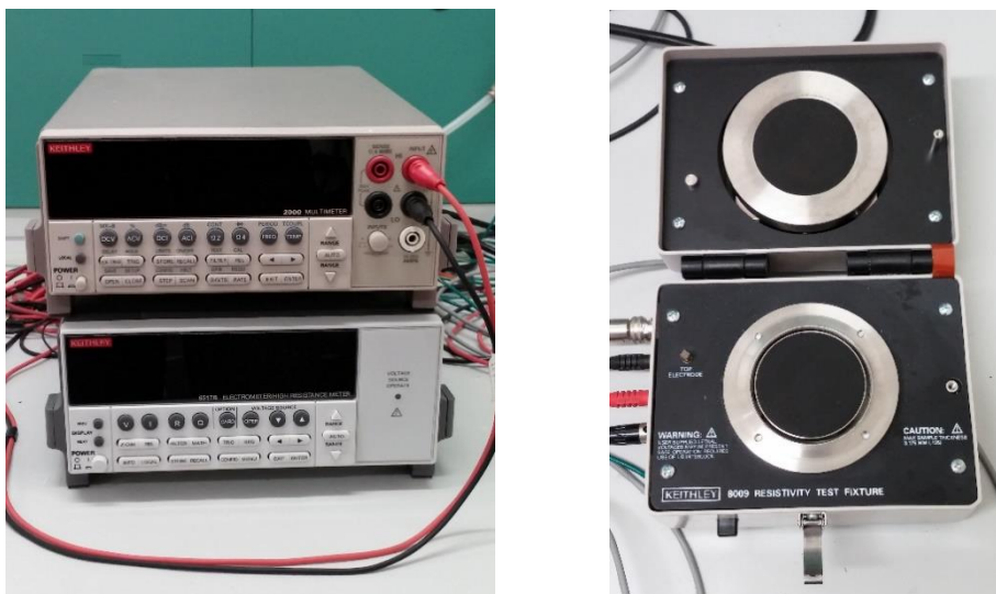
Figura 4.6_A sinistra: elettrometro Keithley modello 6517B; a destra: cella di misura con elettrodi circolari
