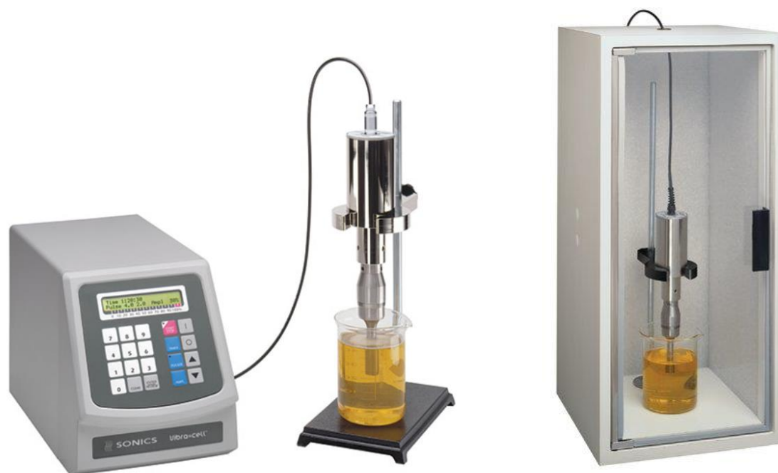
Figura 6.2_A sinistra: sonicatore VibraCell VC505; a destra: sonicatore con box asonoro
