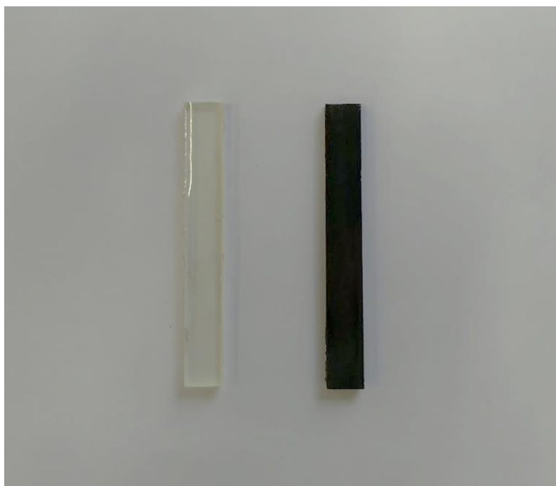
Figura 6.6 _Provini per prove a flessione con indurente alifatico. A sinistra: resina non caricata; a destra: resina caricata con grafite
