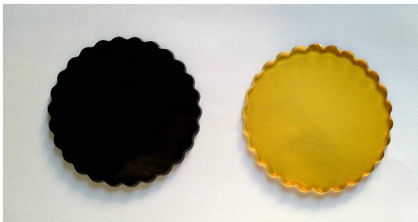
Figura 7.10_Dischetti in resina caricati e non, per prove di resistività elettrica
