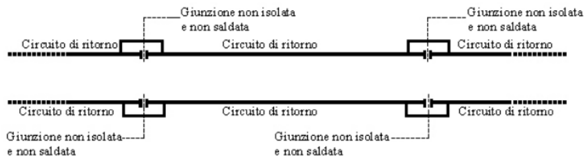
Figura 2.24. Circuito di ritorno con rotaie non isolate
