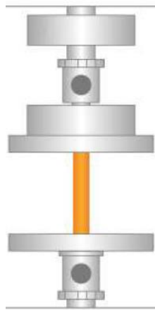
Figura 2.8 – Test a compressione tra piastre parallele [8].
