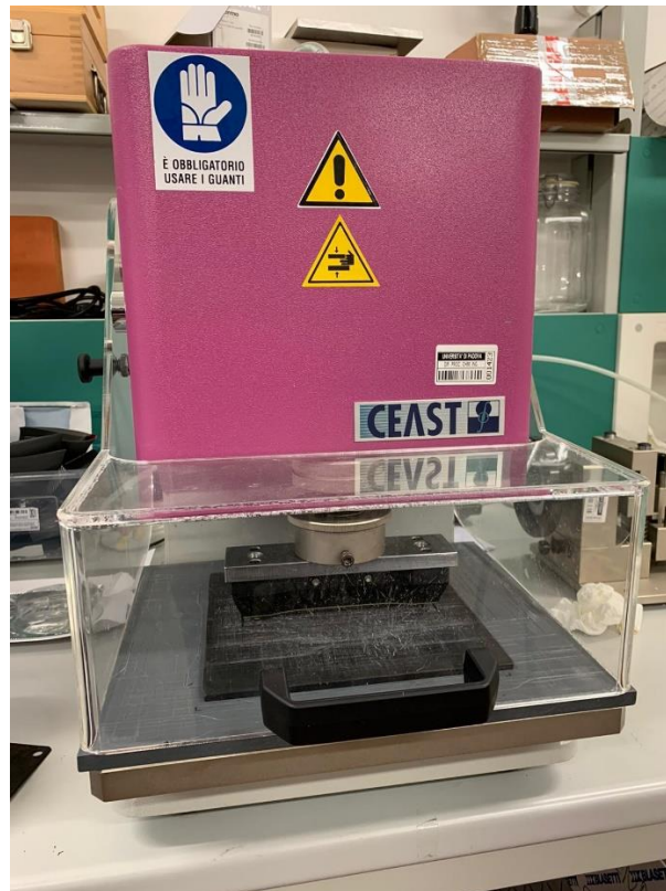
Figura 2.1 – Macchina per tagliare campioni a osso di cane.
