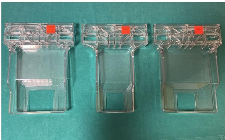
Figura 7: Plate di compressione in PMMA con apertura centrale utilizzati in esami di biopsia.
