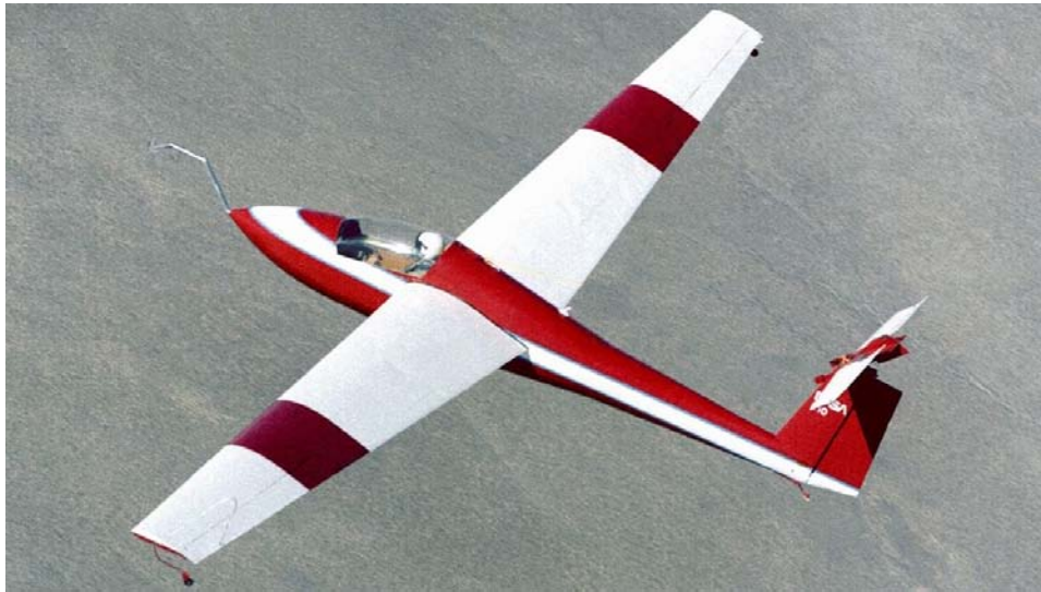
Figura 1.6: Schweizer SGS 1-36 in condizione di stallo profondo (1985).
