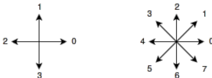
Figura 4.2: Chain Code con direzionamento di 90^\circ e 45^\circ
