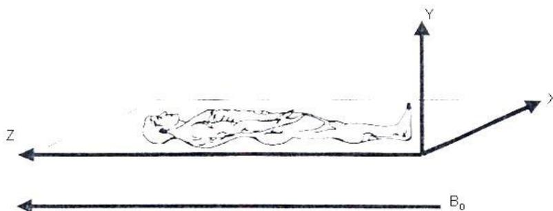
Figura 1.2 - Disposizione degli assi in un tomografo RM [2]
