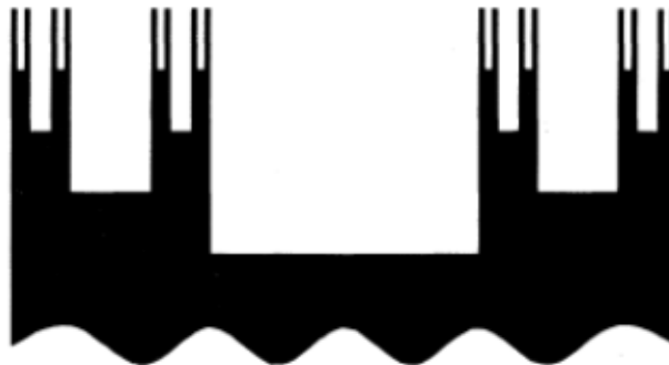
Fig 5.13 : modello Cantoriano 11 di una superficie ruvida tra un elettrolita (in nero) e un elettrodo (in bianco) [5].
