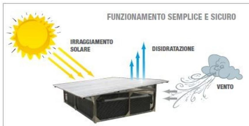
*Figura 7: schema di un heliosecc.*
