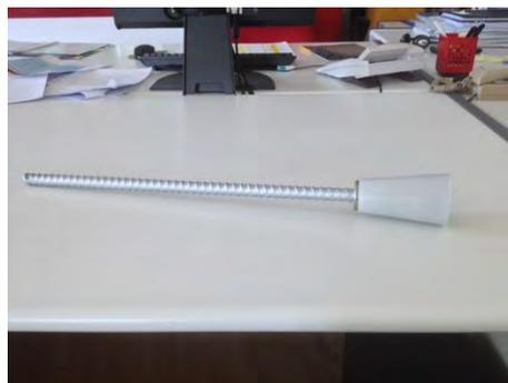
Figura 239. Cono in PVC e barra ancorante
