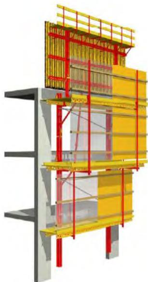
Figura 286. Sistema di autorampata con piattaforme chiuse
