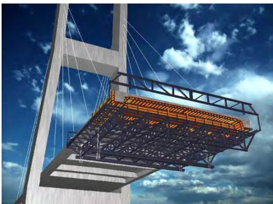
**Figura 330.** Carro per getto conci a sbalzo con struttura portante sottostante
