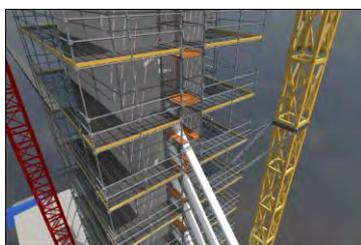
Figura 271. Rendering ponteggio in corrispondenza degli stralli
