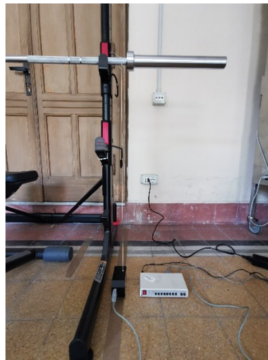
Figura 2.9 Encoder lineare applicato al bilanciere
