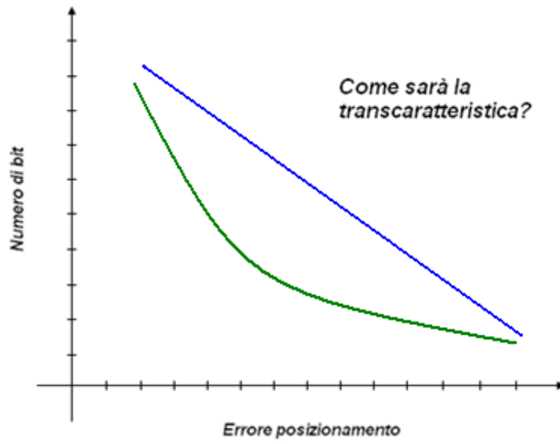
Fig.63 Possibili andamenti dell'errore di posizionamento in relazione al numero di bit
