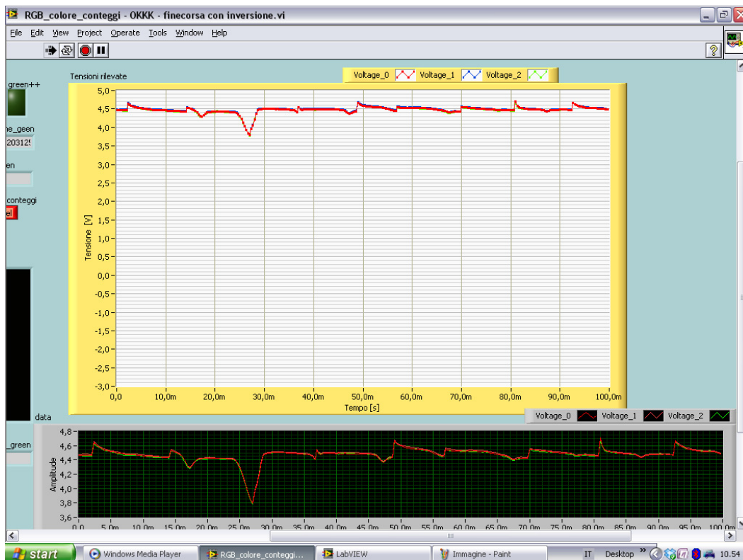
Fig.38 Oscillazioni dei livelli di tensione del sensore a cause dell'azionamento del motore step ad alte velocità
