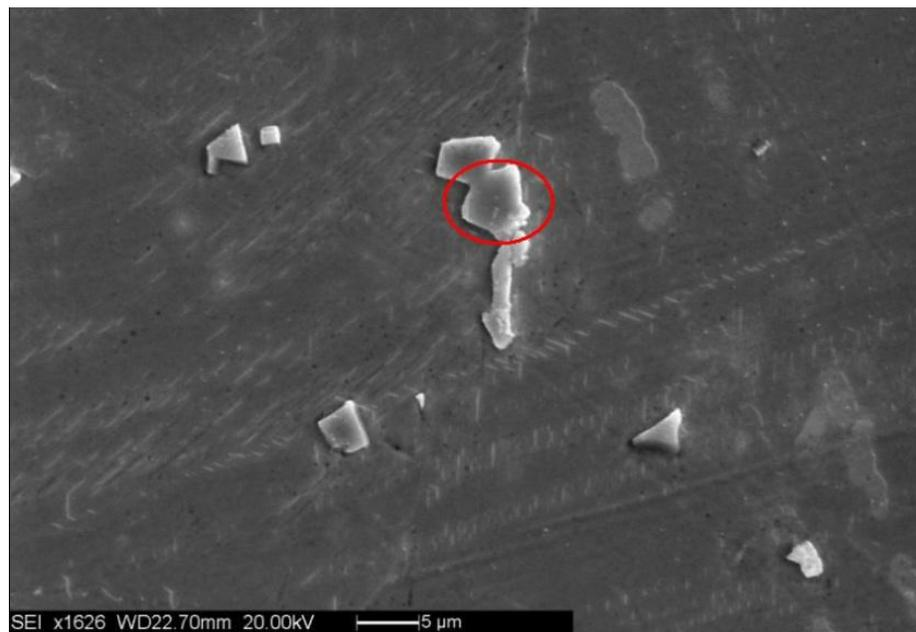
Fig. 5.4.2.1 - Carburo nel bulk
