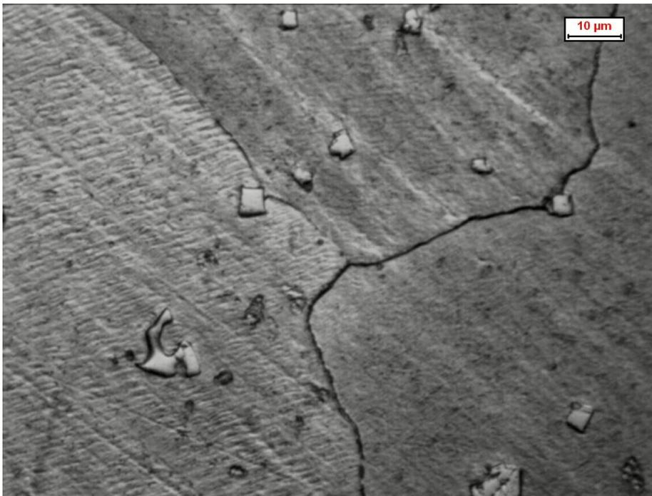
*Fig. 5.6.1.VI – Analisi microscopica dopo attacco con Cogne Unico 1000X*
