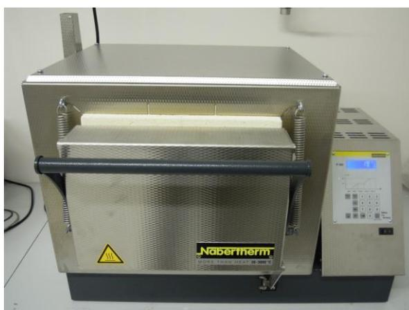
*Fig. 4.1 - Forno da laboratorio Nabertherm*
