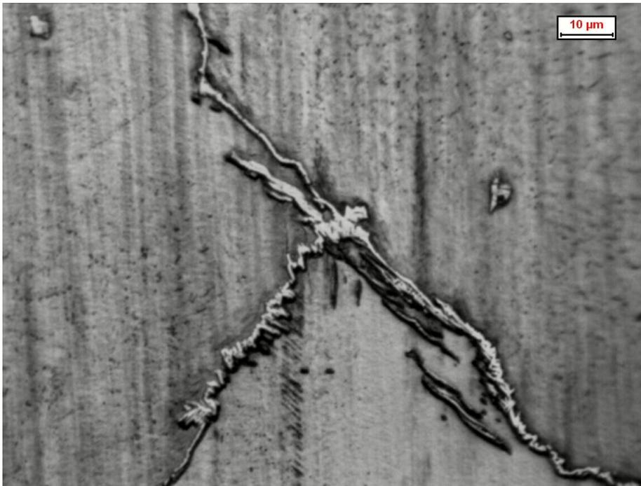
*Fig. 5.6.1.X – Analisi microscopica dopo attacco con Cogne Unico 1000X*
