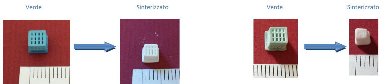
Figura 4.8 Scaffold stampati tramite SL prima e dopo la sinterizzazione per la formulazione contenete filler vetrosi WB1 a sinistra e WB a destra.
