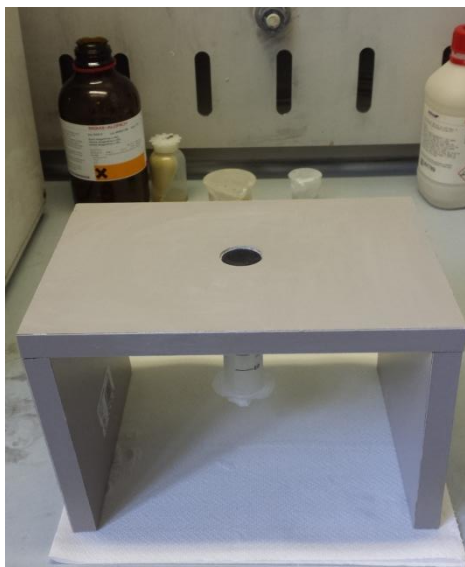
Figura 4.37 Strumento utilizzato per provare la stampabilità del materiale WB2 tramite Power-3D Printing .
