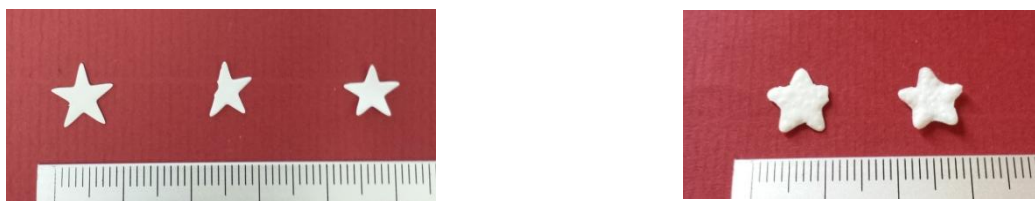
Figura 4.10 Stelline stampate tramite SL per il drop test dopo sinterizzazione con formulazione WB1 a sinistra e WB2 a destra.
