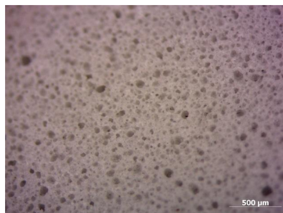
Figura 3.4 Micrografie al microscopio ottico per la schiuma BR1+20% C a 2 mm e 500 µm.
