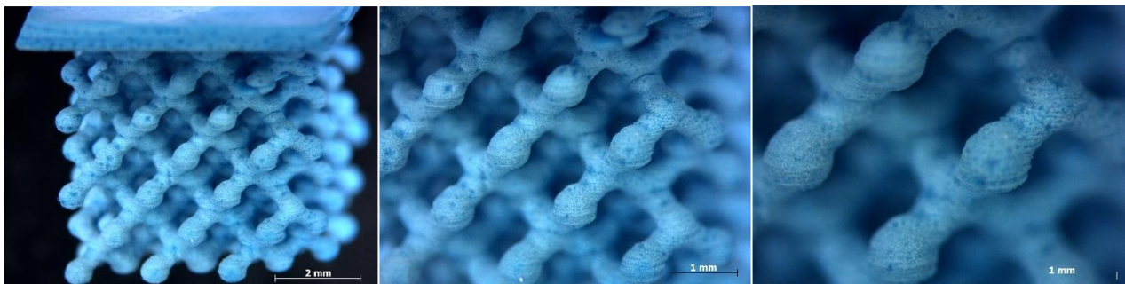
Figura 4.25 Micrografie al microscopio ottico della faccia laterale di una diamond structure WBI verde per diversi ingrandimenti.
