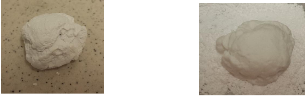
Figura 4.39 Campione WB2 formato tramite P-3DP prima (a sinistra) e dopo (a destra) del trattamento termico.
