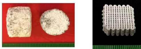
Figura 1.15 Campioni in Biosilicate ® realizzati tramite tecnica PDC presso l'Università di Padova da P. Rebesan et al.: a sinistra schiume e a destra scaffold stampati tramite Robocasting [11].
