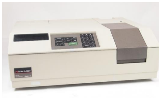
Figura 2.2 Spettrofotometro UV/Vis Lambda 2.
