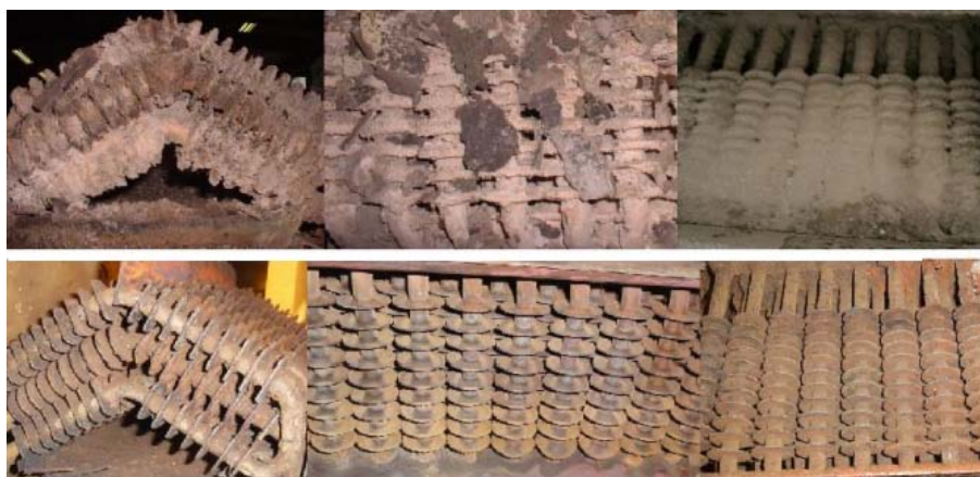
Figura 11: In alto- Stato degli scambiatori di calore nella versione a combustione diretta dopo 300 ore di funzionamento. In basso - Stato degli scambiatori di calore con la gassificazione dopo 4000 ore di funzionamento.
