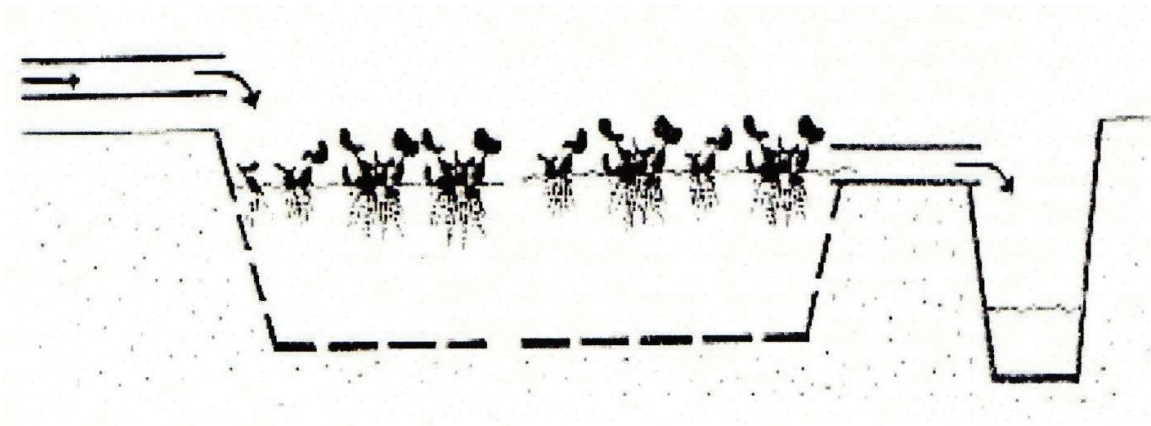
Figura 3 - Rappresentazione di un sistema a macrofite galleggianti con Eichornia crassipes (Brix, 1993)
