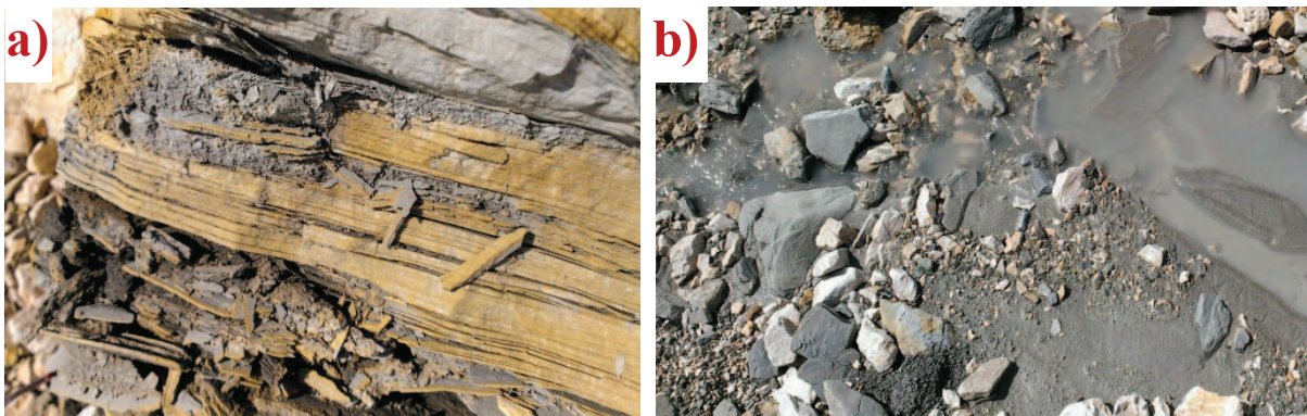
Figura 1.4: Particolare di Flysch in stato roccioso (a) e in stato fangoso (b) (Foto realizzata da me)
