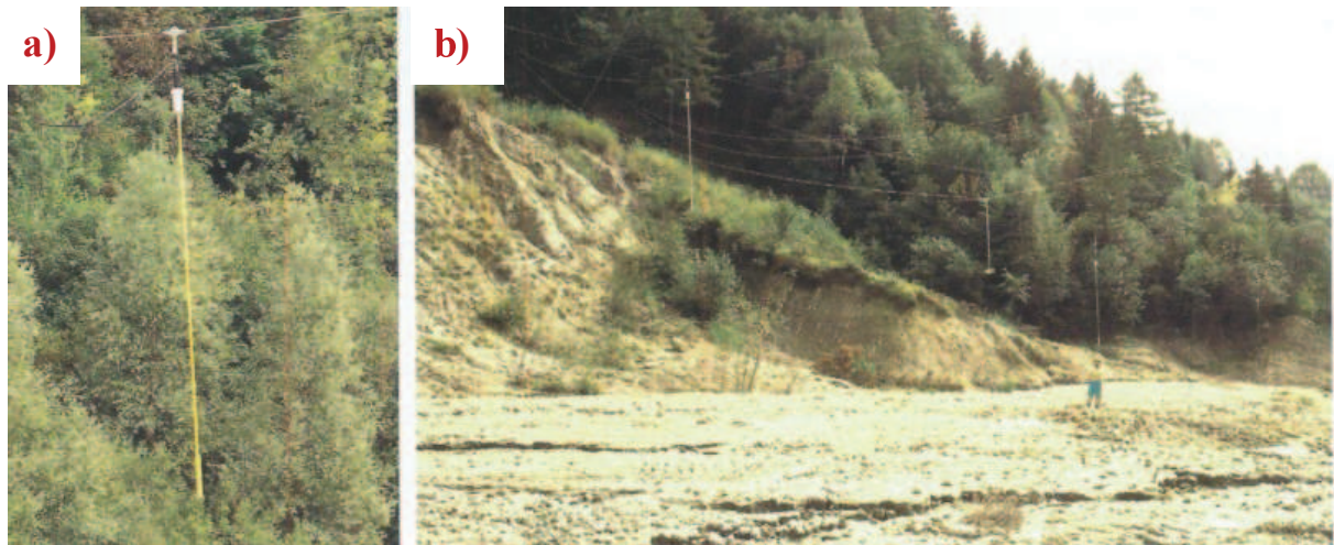
Figura 2.4: Particolare di un'asta direzionale (a) e tre aste direzionali ed un ecometro per il controllo della colata a monte di Funes (b) (A. Pasuto & G. Bossi - La frana del Tessina: Laboratorio naturale per la ricerca applicata alla protezione del territorio )
