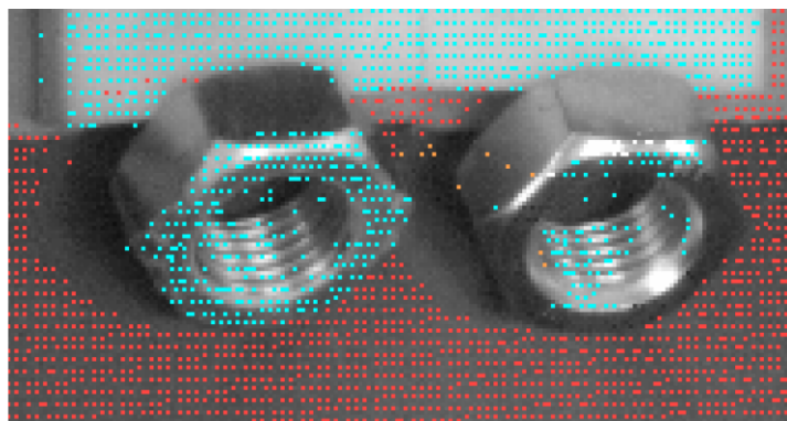
Figura 3.8: Punti della mappa 3D risultati dal 3D Data Preprocess Tool su due dadi inclinati, il dado di destra è come quelli analizzati, quello di sinistra ha la superficie opaca grazie all'applicazione di nastro trasparente con finitura opaca.
