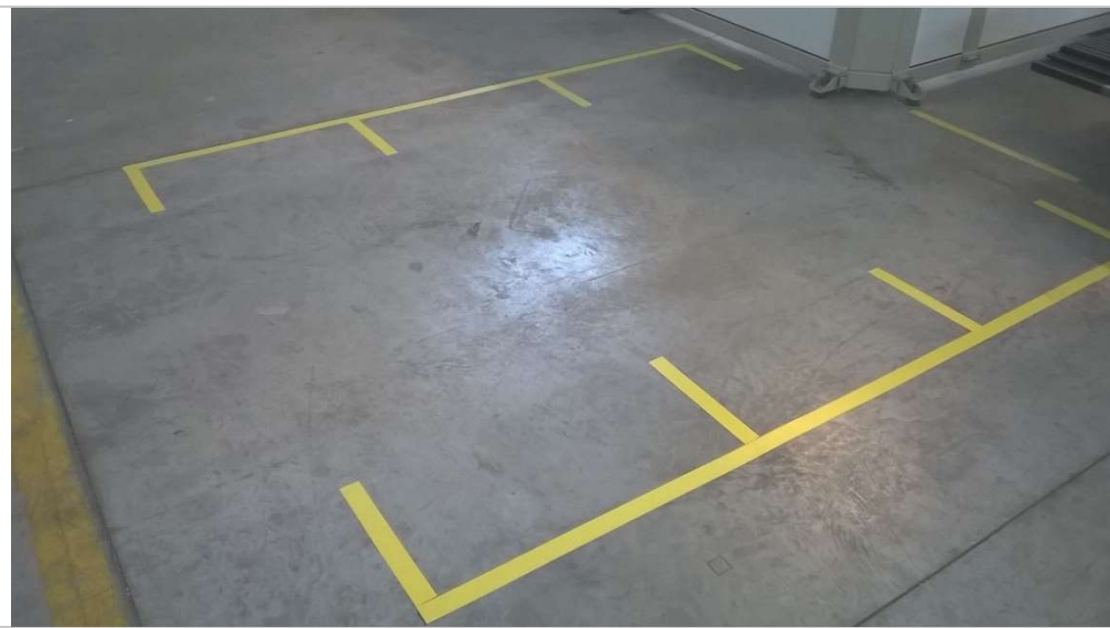
Zona di sosta dei carrelli. I tre slot disponibili limitano il WIP circolante.
