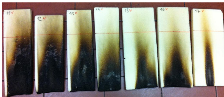
Figura 7.4: Test a spigolo sulla serie 4787-Pentano.
