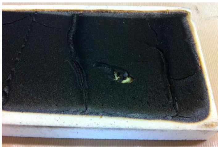
Figura 7.11: Campione 3446-4-Pent dopo test al pannello radiante.
