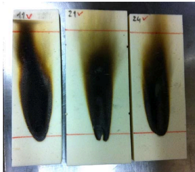
Figura 7.5: Test a parete per campioni a indice 400, da sinistra, basati su poliolo 4787, 4826, 3446.
