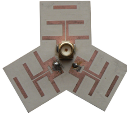
Figura 5.1: Prototipo dell'array di 3 Yagi realizzato in laboratorio. Immagine in scala 1:1.
