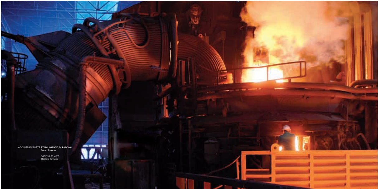
Fig. 1.3 EAF di Acciaierie Venete, a sinistra si nota il brandeggiabile e sopra la volta il tronchetto
