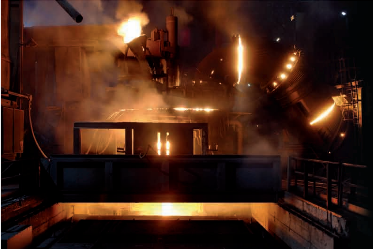
Fig. 1.2 Foto dell' EAF installato nello stabilimento padovano di Acciaierie Venete in esercizio
