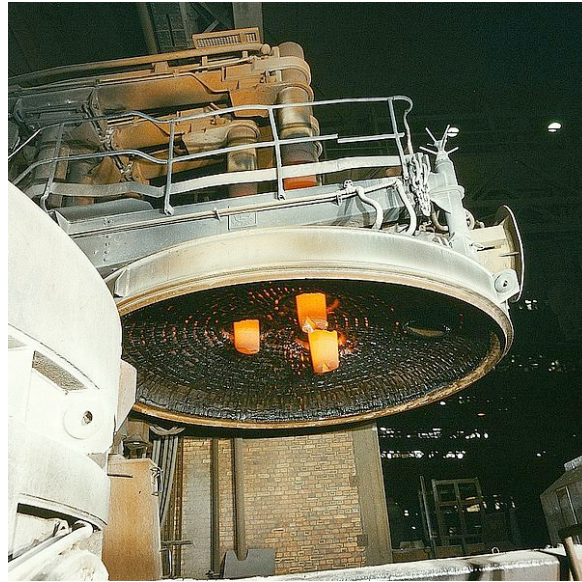
Fig. 1.1 Volta di un EAF vista dall'interno
