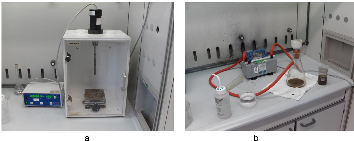
Fig. 4.3 (a) Sonicator Bandelin HD3200 completo di sonotrodo in lega Ti-Al-V, (b) filtrazione con pompa a membrana e beuta
