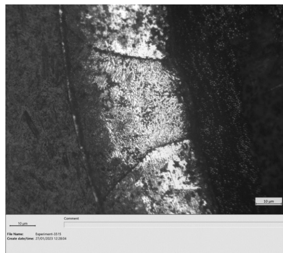
Microscopio ottico a 50x, 100x e 200x (Filo ibrido con saldatura laser, 2 passaggi in filiera)
