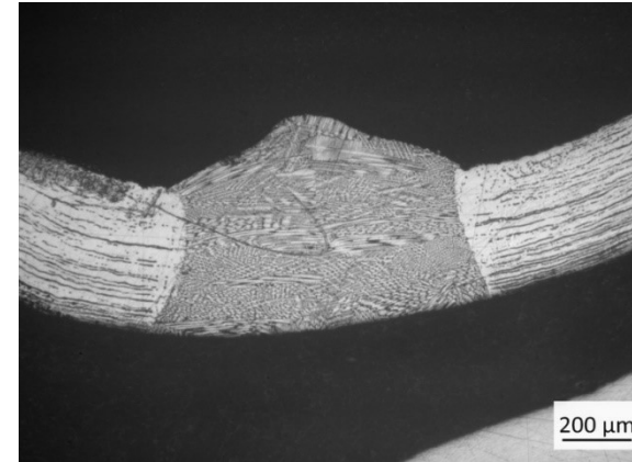
Microscopio ottico a 50x, 100x e 500x (Filo ibrido con saldatura TIG)
