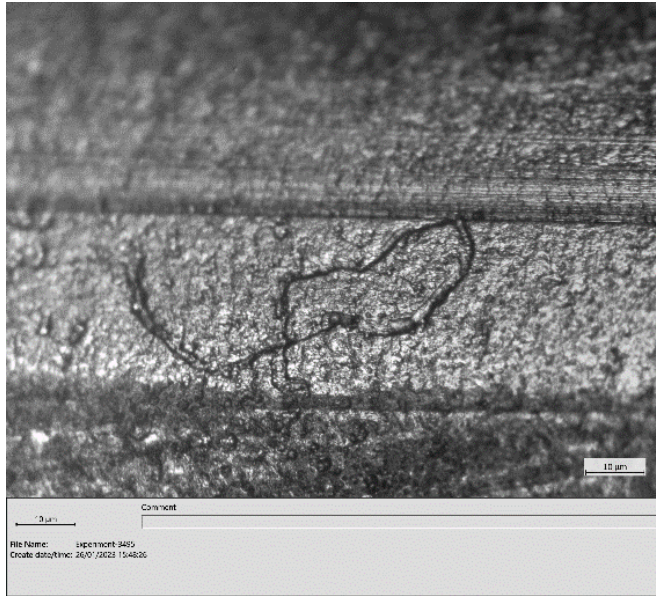
Stress corrosion cracking test Filo Ibrido piegato saldatura laser 2 passaggi in filiera (immagini OM)
