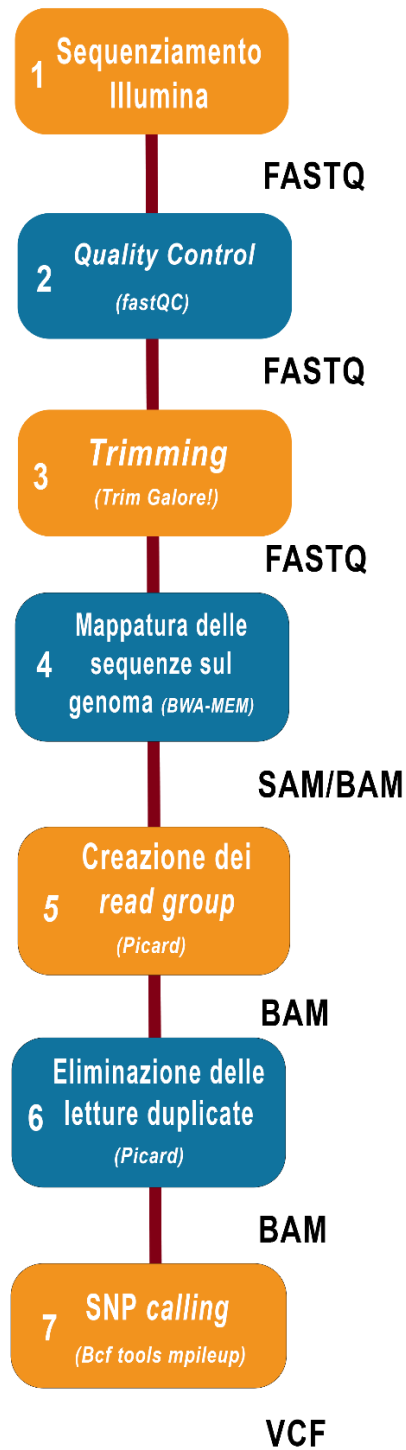
Figura 16. Schematizzazione del workflow utilizzato per le analisi bioinformatiche
