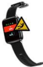
*Figura 9: Dispositivo di tipo uomo a terra indossabile [32]*
