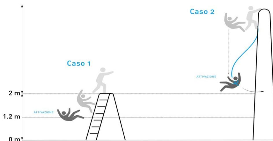
Figura 111: Situazioni in cui il dispositivo Work-air di Dainese può essere utilizzato [23]
