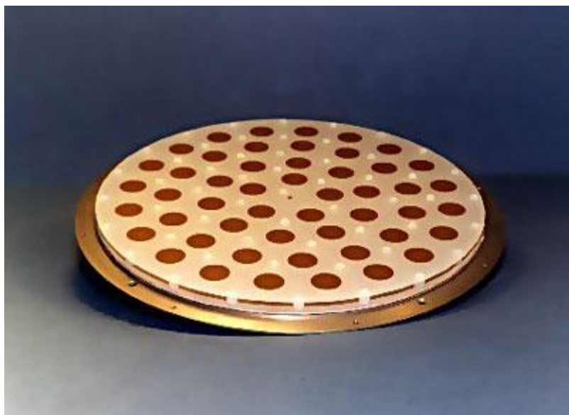
Fig.2) Array di patch circolari
