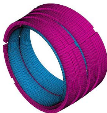
Fig. 5.1: Dettaglio della mesh su PSS e TSS
