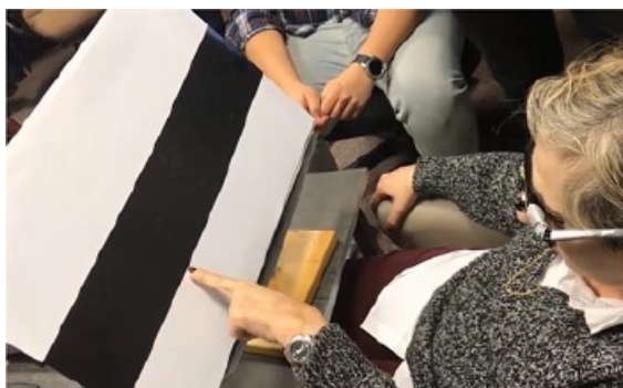
Figura 96. Il soggetto riesce ad individuare il bordo tra bande nere e bianche utilizzando il codificatore retinale [39].
