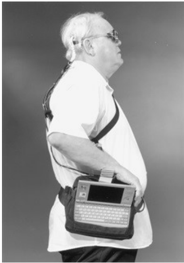
Figura 87. Sistema di visione artificiale sviluppato da Dobelle e Mladjilovski [38].
