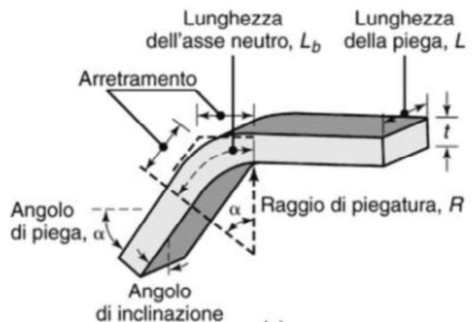
Figura 3.23 Schema di piegatura della lamiera.
