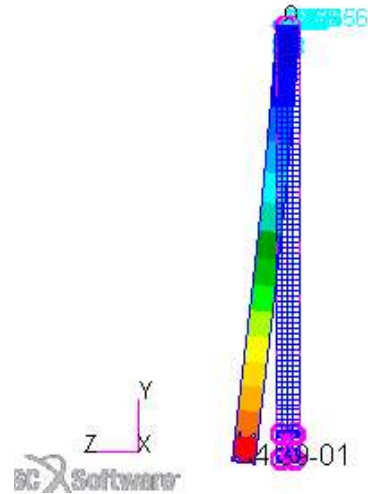
Figura 3.40 Interfaccia Patran; secondo modo di vibrare in vista yz.
