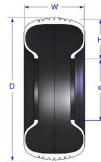
Figura 1.35 Dimensioni caratteristiche di uno pneumatico [9, pg.557].
