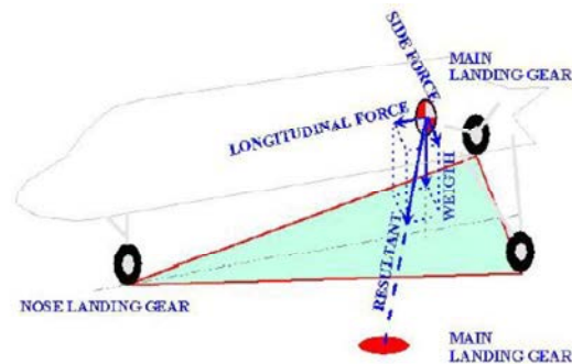
Figura 1.9 Condizione di stabilità durante il rullaggio [7, pg.8.5].
