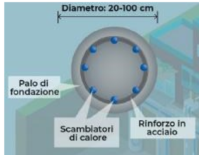
Palo di una geostruttura
