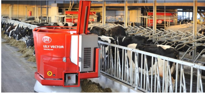
Figura 2.5: Robot per l'automatizzazione dell'alimentazione delle bovine da latte (Massimo Brambilla, 2021).
