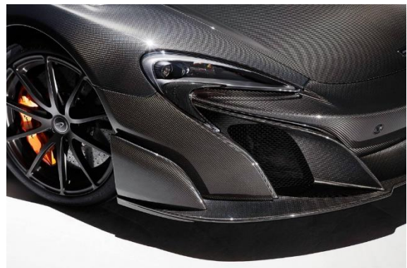
Figura 1.1. Applicazione nel settore automotive di compositi in fibra di carbonio con rinforzo in tessuto.
