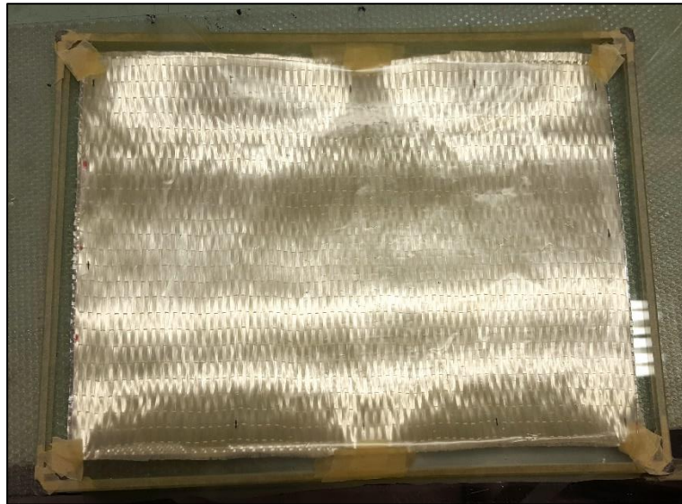
Figura 2.5. Applicazione del microforato sopra gli strati di rinforzo.
