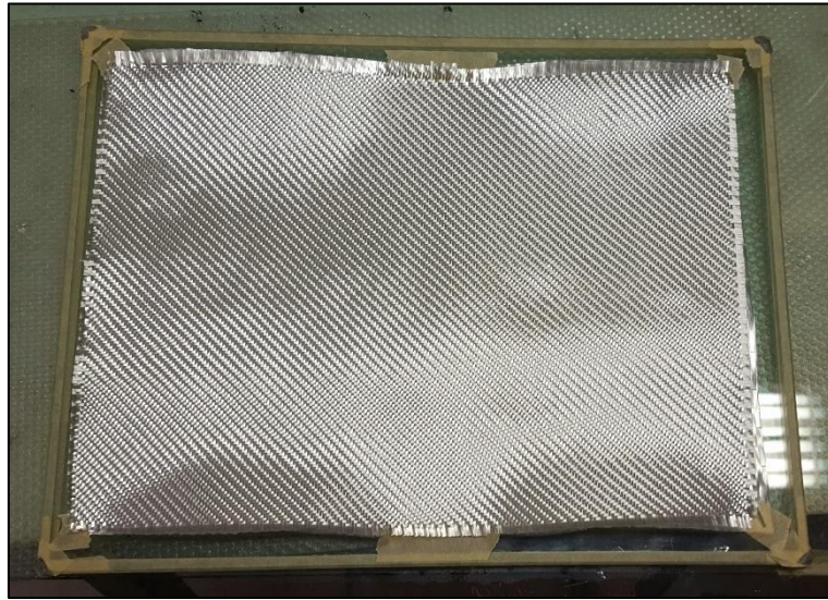
Figura 2.3. Stesura strato rinforzo in tessuto twill 2x2.
