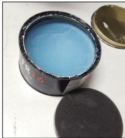
Figura 2.2. Cera per favorire il demolding.
