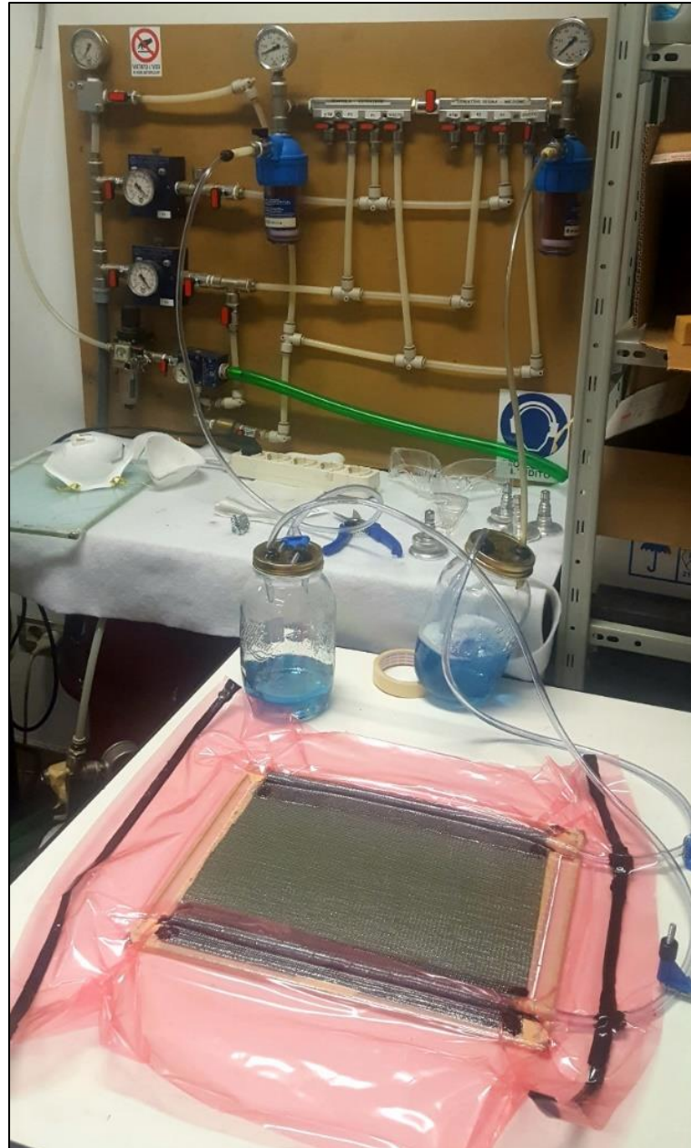
Figura 2.11. Stampo collegato al sistema di iniezione della resina e pronto all'infusione.
