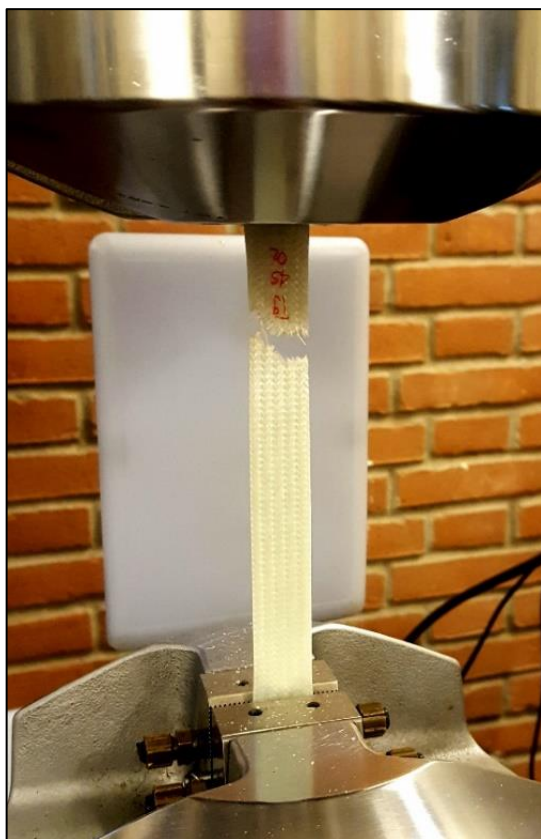
Figura 3.1. Rottura statica del provino t9-45.02.
