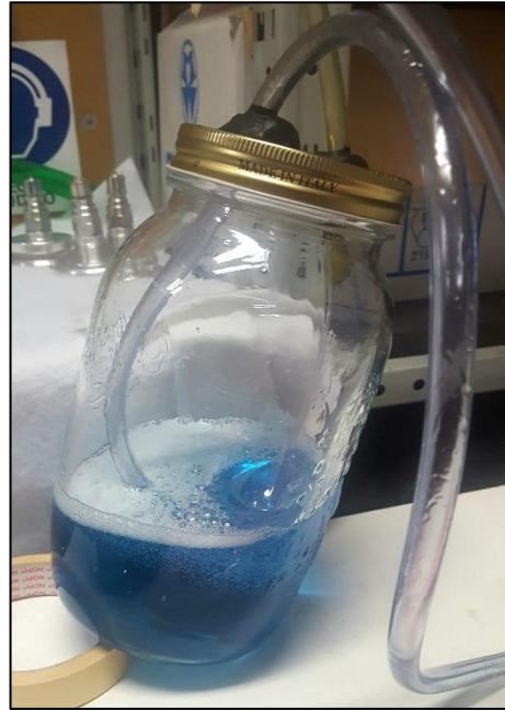
Figura 2.10. Eliminazione dell'aria contenuta all'interno della resina.
