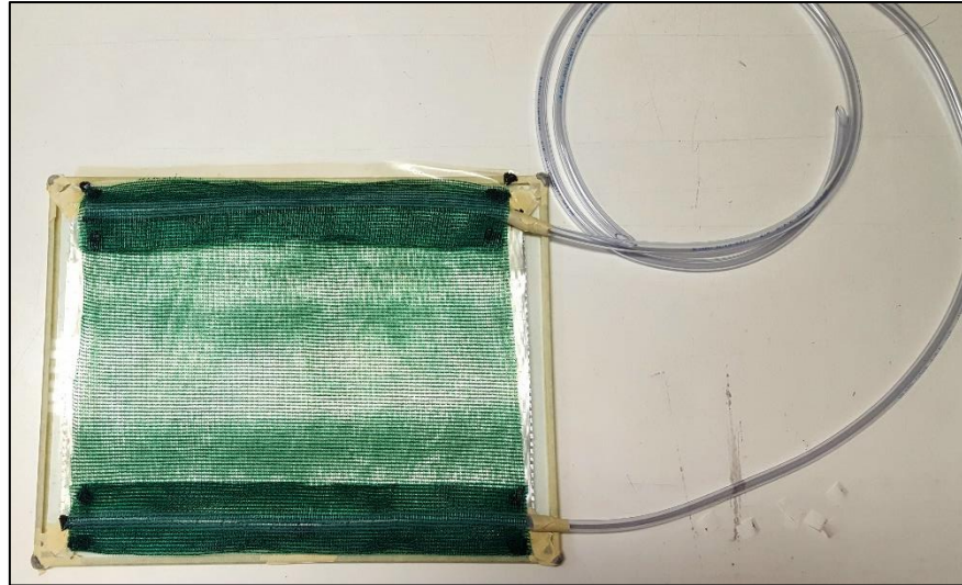
Figura 2.7. Applicazione dei canali di iniezione ed uscita della resina.
