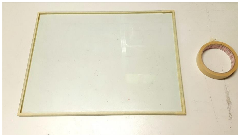
Figura 2.1. Preparazione dello stampo in vetro.
