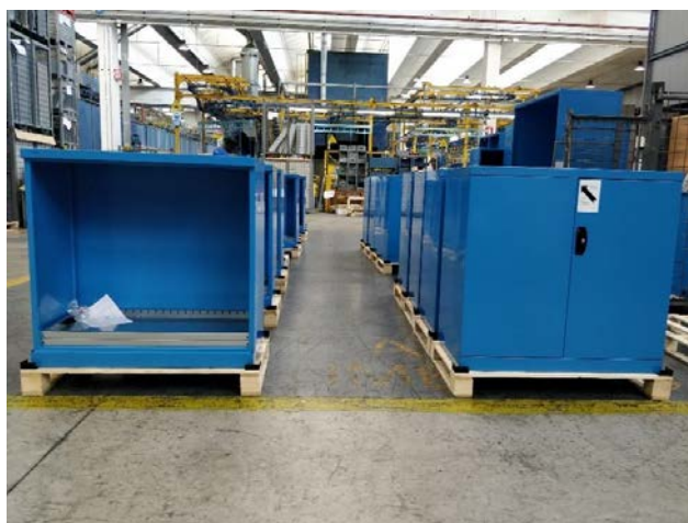
Figura 32: Allestimento di armadi FAA12005104 nell'area compresa tra il reparto M03 e la verniciatura; sulla destra si può vedere l'armadio completo, sulla sinistra invece in attesa del montaggio delle porte
