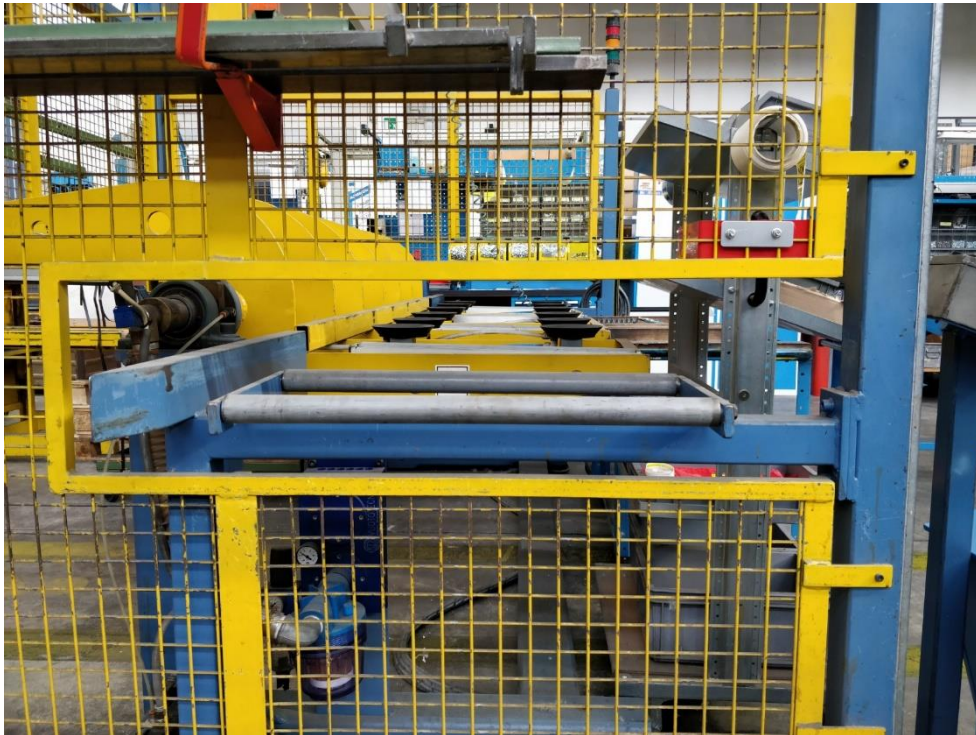
Figura 42: Fessura di entrata dei piani della macchina gira banchi
