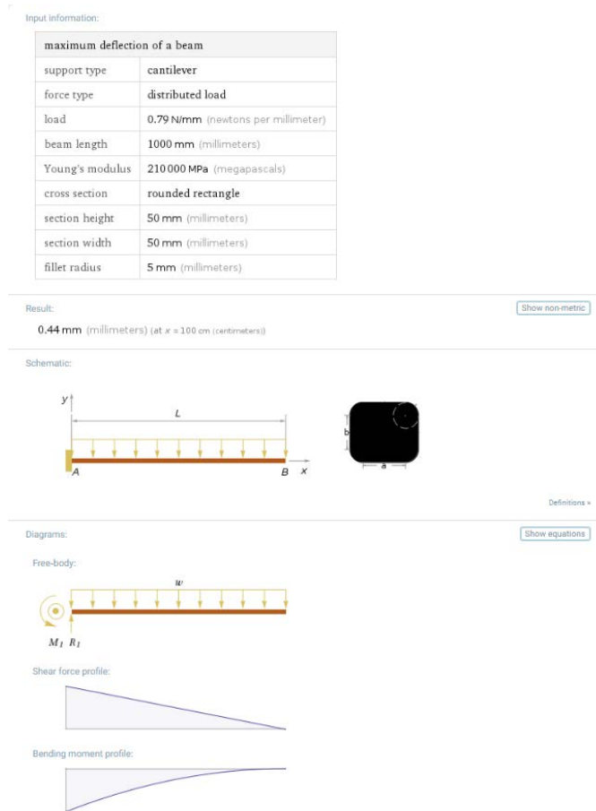
Figura 95: Analisi della trave a incastro
