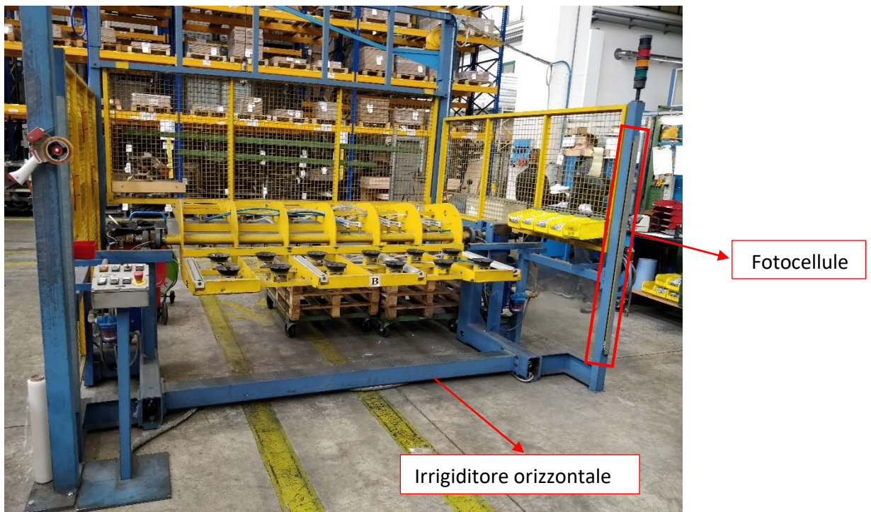
Figura 43: Vista frontale della macchina gira banchi
