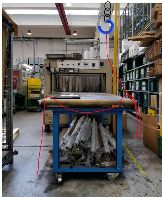
Figura 77: disegno a mano della posizione in cui dovrebbero essere il gancio e una delle brache mentre aspettano l'uscita del banco
