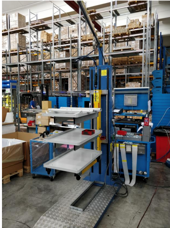
Figura 50: Macchinario per il montaggio dei carrelli. In figura sono già posizionati sui supporti la base con le ruote montate e il piano superiore e intermedio in attesa di essere collegati dai montanti.
