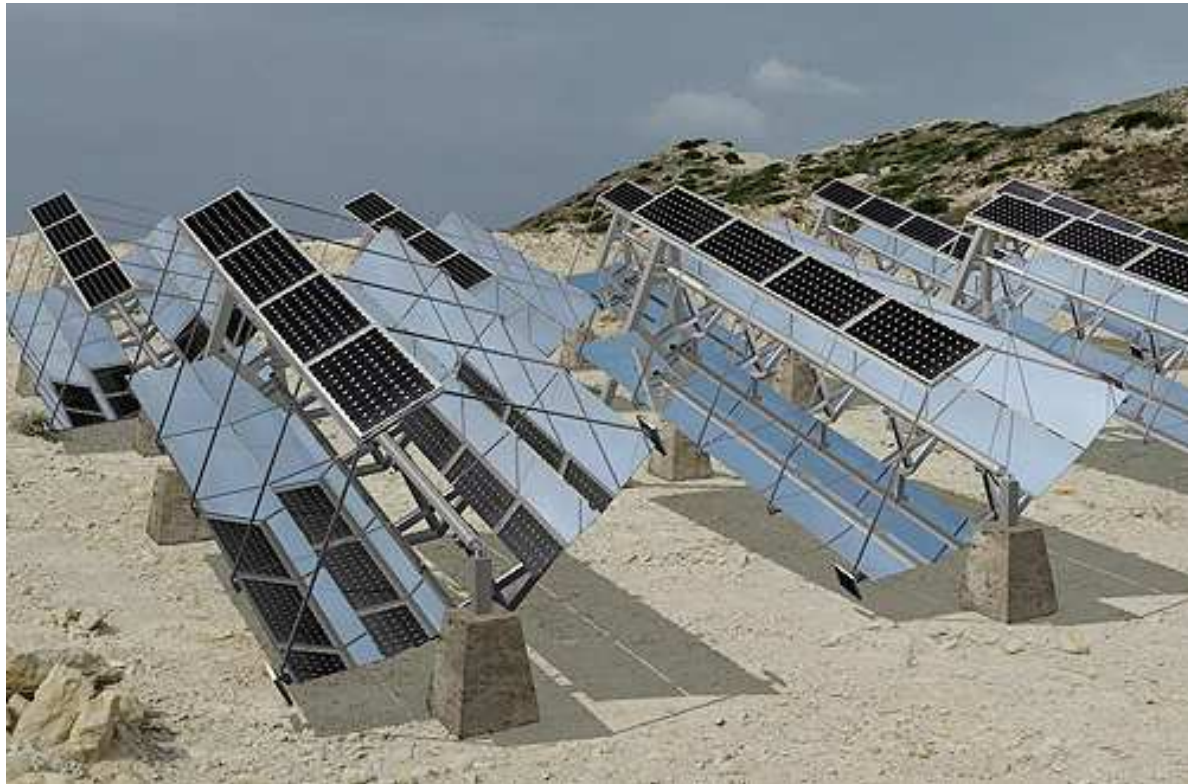
Figura 8.2: moltiplicatore con pannello bifacciale
