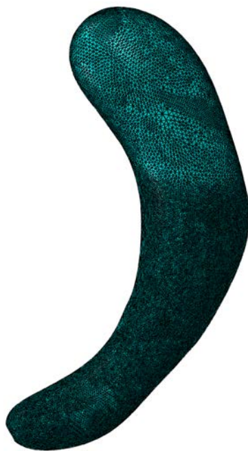
(c) Modello computazionale: 112361 nodi e 518281 elementi
