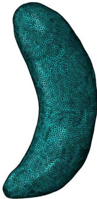
(c) Modello computazionale: 72 268 nodi e 336 240 elementi
