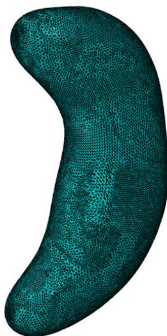
(c) Modello computazionale: 126 385 nodi e 632 303 elementi
