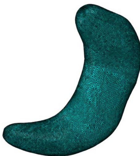
(c) Modello computazionale: 81 269 nodi e 356 922 elementi
