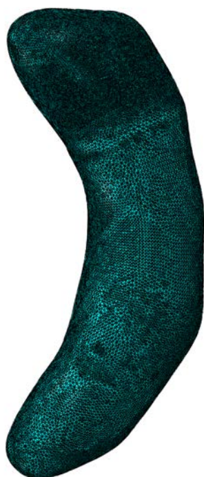
(c) Modello computazionale: 84548 nodi e 354782 elementi
