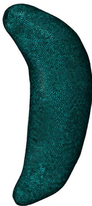
(c) Modello computazionale: 95 050 nodi e 455 747 elementi
