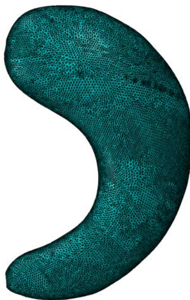
(c) Modello computazionale: 136 644 nodi e 672 184 elementi
