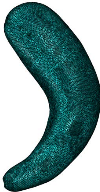
(c) Modello computazionale: 105 771 nodi e 519 496 elementi
