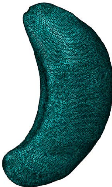
(c) Modello computazionale: 105 480 nodi e 506 196 elementi
