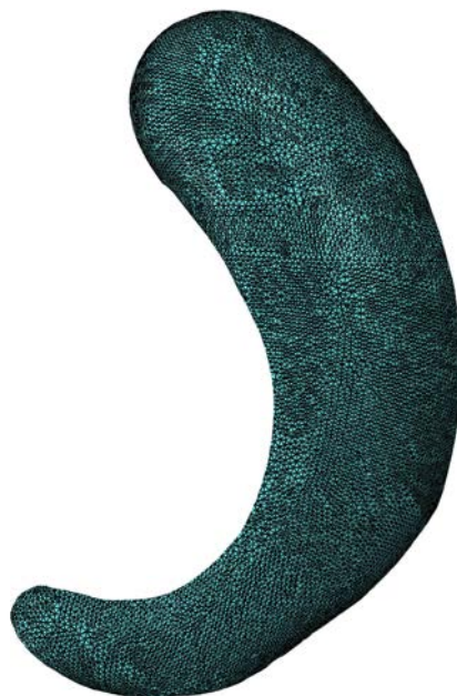
(c) Modello computazionale: 89 466 nodi e 403 469 elementi
