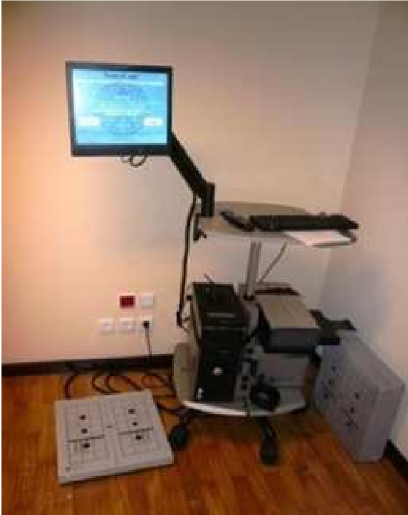
Fig. 8 Pedana stabilometrica utilizzata per lo studio con computer, software, pedana statica e cuscino per eseguire la stabilometria dinamica.
