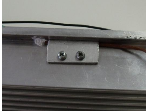
Figura 5.5 Collegamento termico tra termocoppia e dissipatore della lampada.
