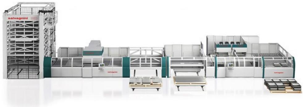
*Figura 1.7 Linea automatica Salvagnini con magazzino automatico*
