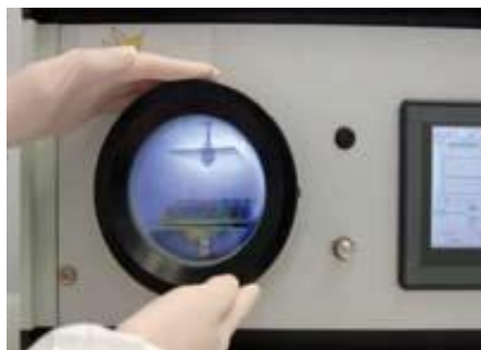
Figura 5.19: Decontaminazione al plasma freddo di argon.
