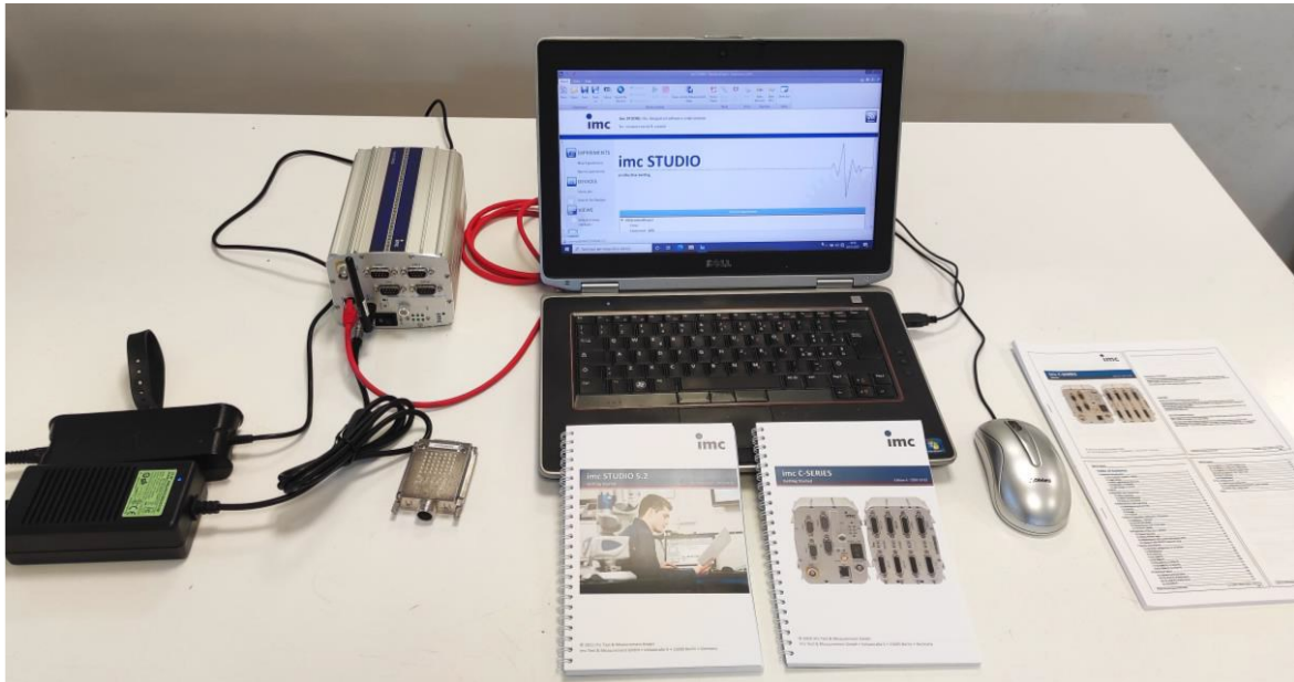
Figura 4.3 Set up della centralina IMC CS-7008-FD [29].
