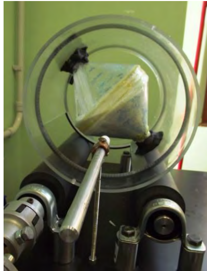
Figura 4.3. Cilindro di plexiglass contenente il miscelatore biconico simmetrico a mescolamento completato
