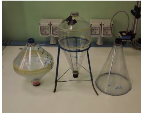
Figura 2.14. Rappresentazione dei tre miscelatori in esame. Da sinistra verso destra: mixer biconico simmetrico, mixer biconico asimmetrico e mixer conico
