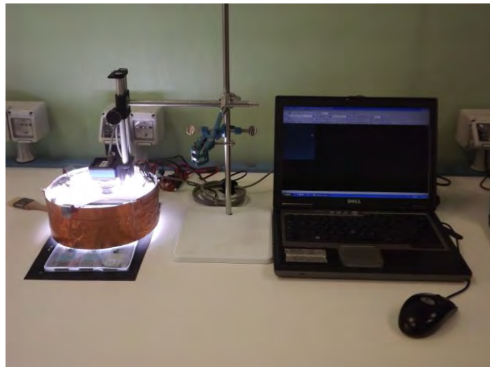
Figura 2.2. Attrezzatura utilizzata per l'acquisizione delle immagini: piastrina porta campioni, corona di luci a led, fotocamera con supporto regolabile e computer con software IC Capture per l'acquisizione delle immagini
