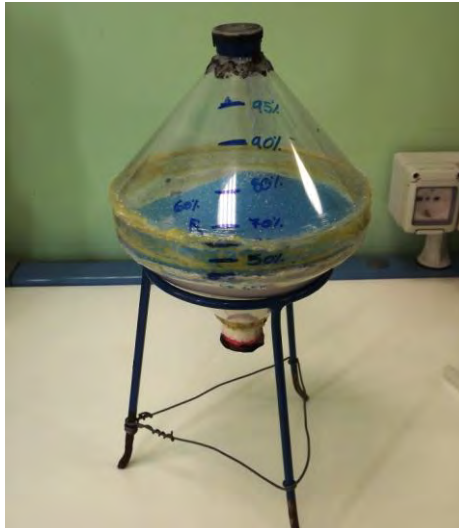
Figura 4.2. Rappresentazione del caricamento del mixer prima dell'esperimento: TAED bianco sul fondo e TAED blu in sommità
