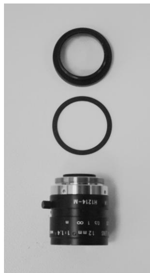
Figura 3.2. Dall’alto verso il basso: distanziale da 5 mm, distanziale da 1mm e obiettivo Pentax® 12mm
