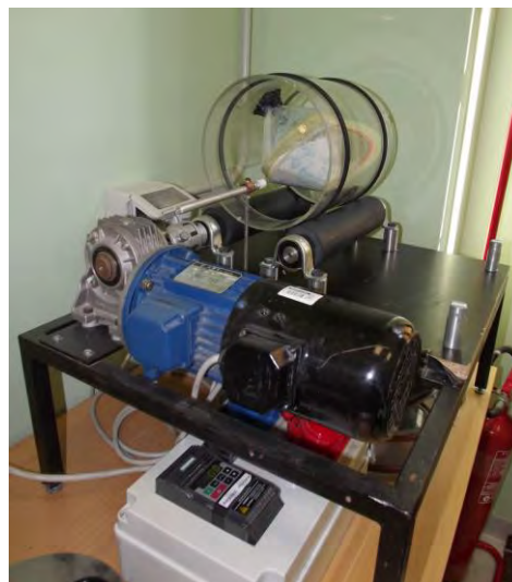
Figura 2.3. Apparato per la miscelazione: rulli gommati con motore, cilindro in plexiglass e contenitore biconico per la miscelazione
