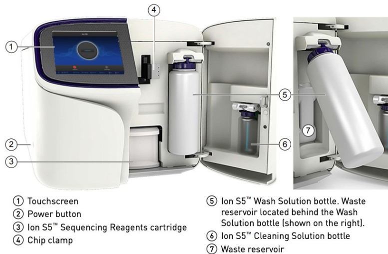
Figura 15. Schema di organizzazione dei componenti dello strumento Ion S5.
