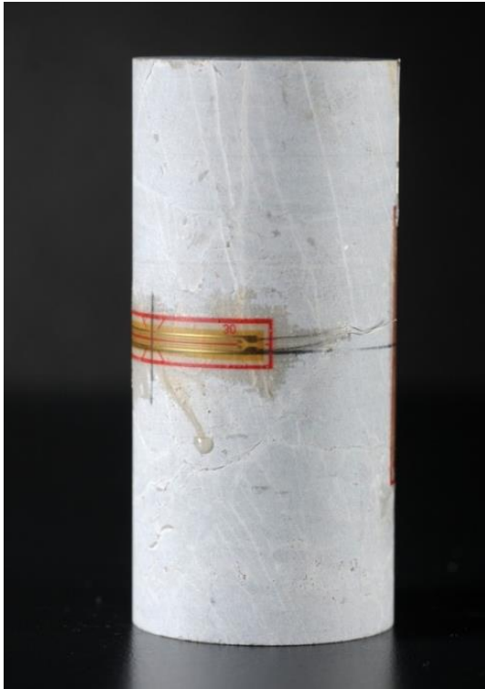
Figura 28: Campione cilindrico prima della prova a compressione, su cui sono già stati fissati gli estensimetri.
