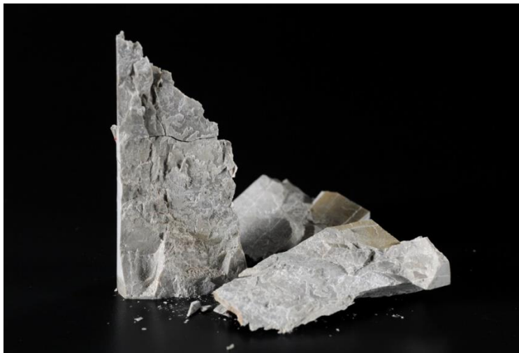
Figura 29: Campione AU2 successivamente all'esecuzione della prova a compressione semplice. Il provino si è fratturato totalmente.
