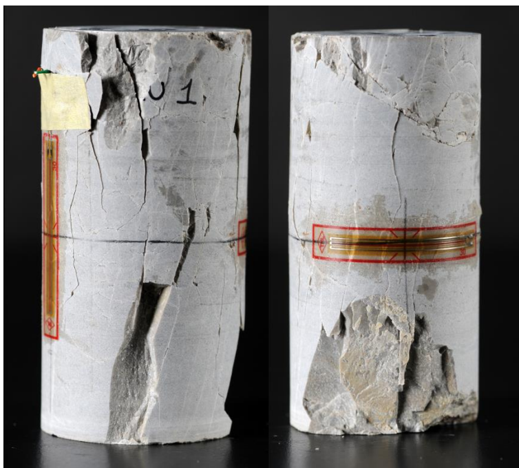
Figura 30: Campione AU1 successivamente alla prova di compressione semplice. Si può notare come la rottura non sia netta, ma è parziale in confronto al campione AU2.
