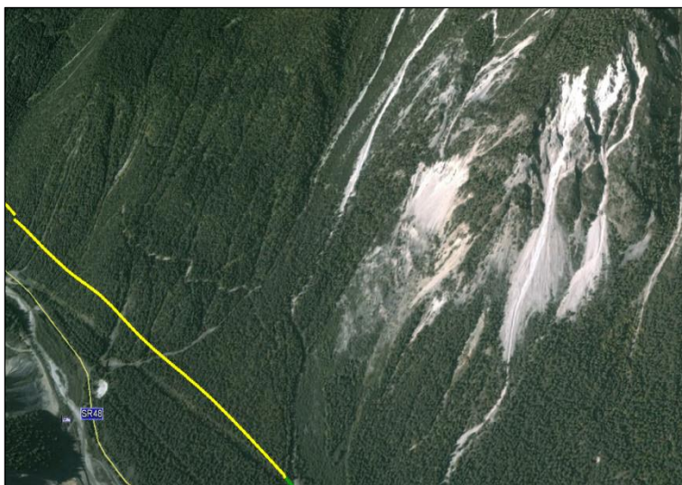
Figura 14: Frana sul versante meridionale del Col di Vezza. Intorno si sono verificati vari fenomeni di colata detritica lungo i canali esistenti, con un elevato trasporto di materiale.
